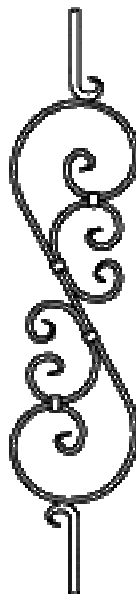
EIW 107 □12-16 / Ø14mm SCROLLS : 16 x 8mm 690 H x 215 W HEB / PL
