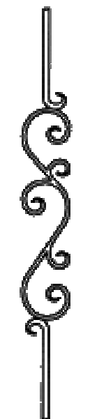
EIW 129 □12-16 / Ø14 SCROLLS : 16 x 8mm 515 H x 115 W HEB / PL
